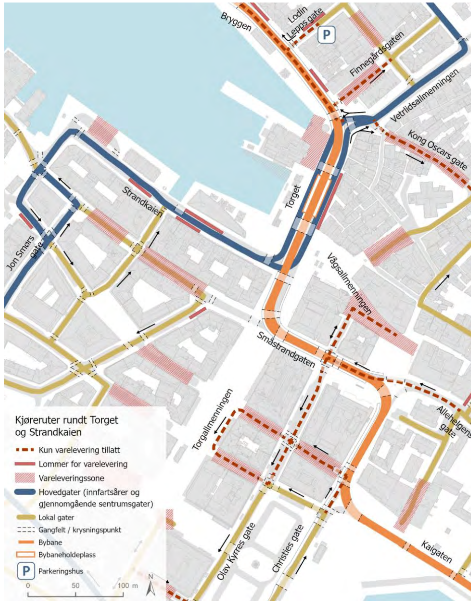
Figur 6-42: Kjøreruter rundt Torget og Strandkaia. Figuren viser blant annet kjøremønster og gangfelt/krysningspunkt.
