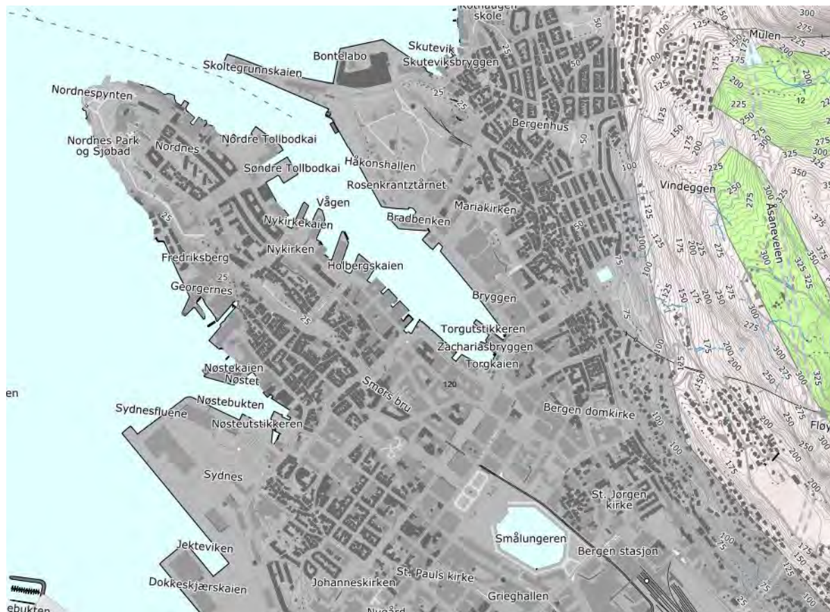
Figur 5-27: Det kvartærgeologiske kartet over Bergen sentrum viser karakteristikk "Fyllmasser" for området for delstrekning 1 (DS1) i sentrum mellom Smålungeren, Vågen, Skuteviken og Skansen (ref. Norges geologiske undersøkelse).
